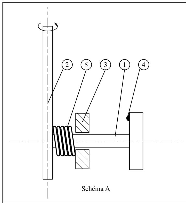
Une tige horizontale (1) de longueur  $\ell$  est solidarisée perpendiculairement à un arbre (2) d'une machine tournant à une vitesse angulaire constante  $\omega$ . Un ressort (5) de constante de raideur  $k$  est fixé par l'une de ses extrémités à l'arbre et
