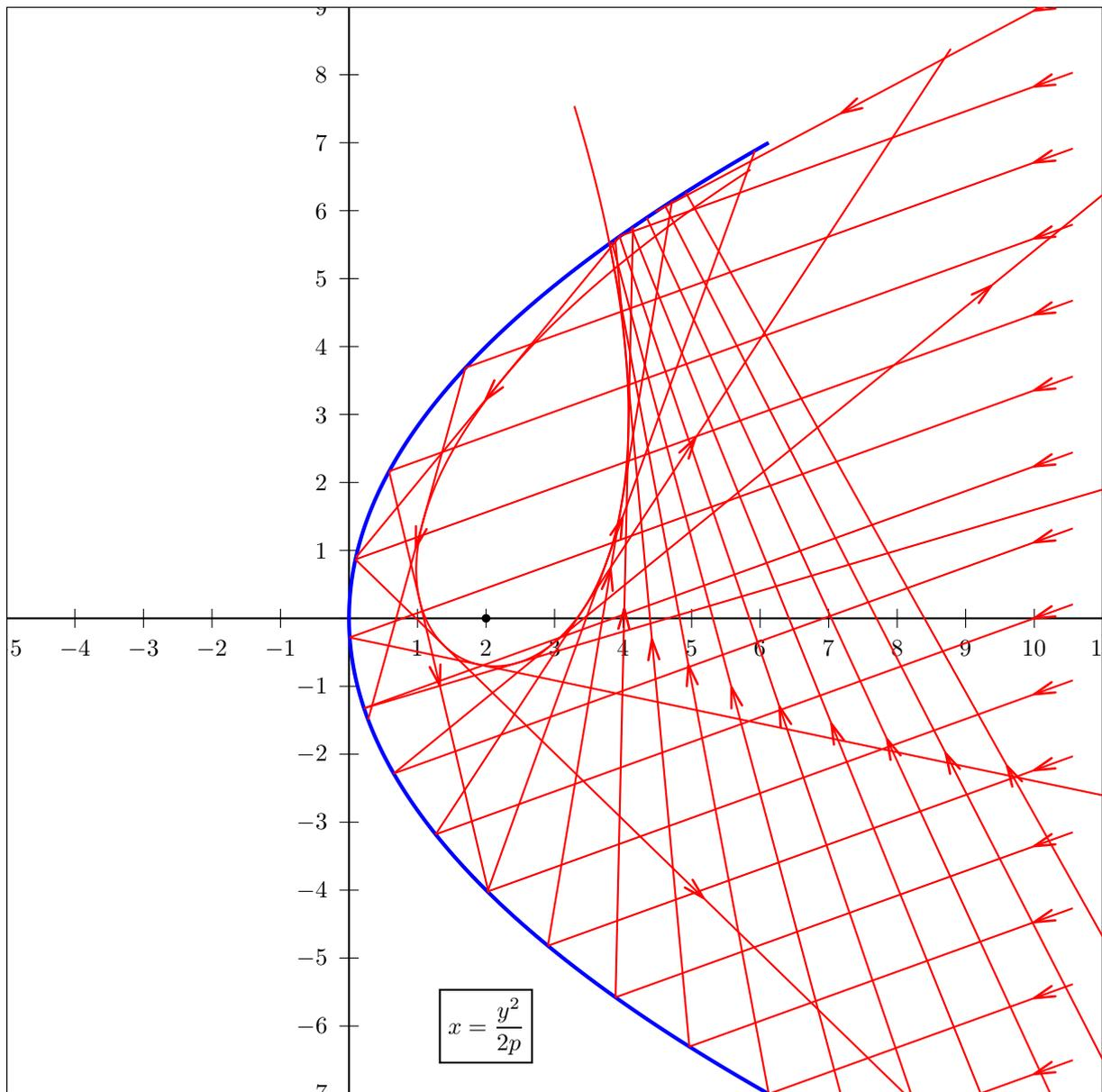
On détermine l'angle que fait le rayon réfléchi avec l'axe  $Ox$ ,  $(x_M, y_M)$  sont les coordonnées du point d'incidence sur la parabole :
