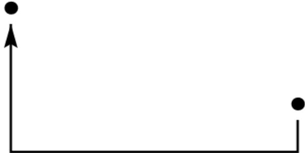
La commande **pcbar** trace d'abord les bras de longueurs respectives  $armA$  et  $armB$  à un angle  $angleA$ . Ensuite, l'un des bras est étendu puis connecté, de telle façon que la ligne finale soit composée de 3 segments à angle droit.
