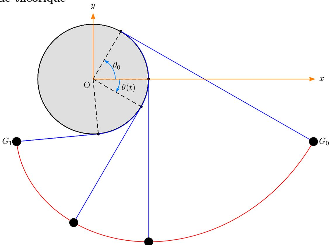
Le pendule, dans diverses positions, le fil est toujours tendu : position initiale  $G_0$ , positions intermédiaires et position extrême  $G_1$  laquelle est au même niveau que la position initiale.
