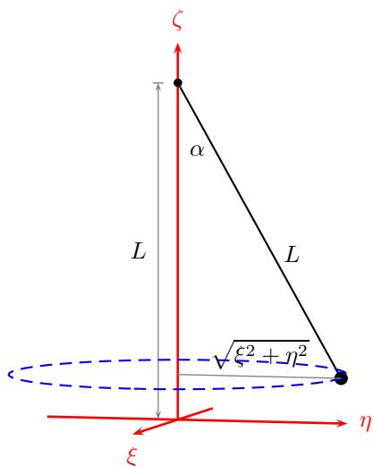
Mettons la suspense fixe du pendule de la longueur  $L$  à  $(0/0/L)$  et déplaçant la masse avec une angle petite  $\alpha$  on peut déduire :
