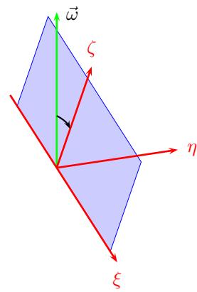
Les vecteurs  $\vec{\omega}$ ,  $\vec{\xi}$  et  $\vec{\zeta}$  sont dans un même plan. Les coordonnées de  $\vec{\omega}$  sont :
