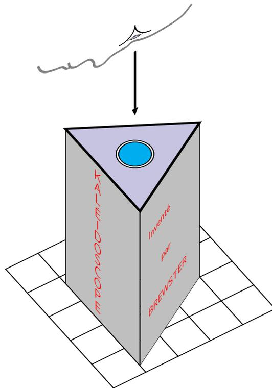
Un kaléidoscope est constitué de 3 miroirs formant un prisme équilatéral. La base est fermée par deux lames parallèles, l'une est transparente l'autre en verre dépoli (pour laisser passer la lumière). Entre ces deux faces on place des petits bouts de plastique colorés.
