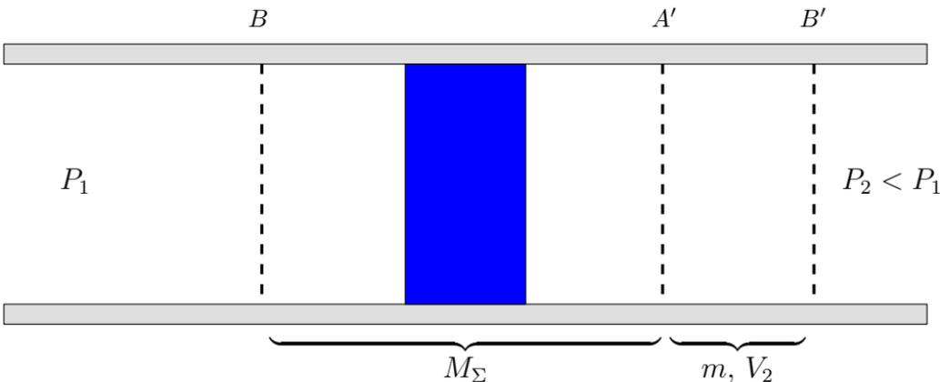
(b) À l'instant  $t_2$ , la même masse a traversé la paroi poreuse et est du côté (2) entre  $A'$  et  $B'$  à la pression  $P_2$  et à la température  $T_2$ . Elle occupe maintenant un volume  $V_2 > V_1$  car  $P_2 < P_1$ .
