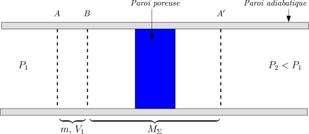
(a) À l'instant  $t_1$ , la masse  $m$  de gaz comprise entre  $A$  et  $B$  est du côté (1) à la température  $T_1$  et à la pression  $P_1$ . Elle occupe un volume  $V_1$ .
