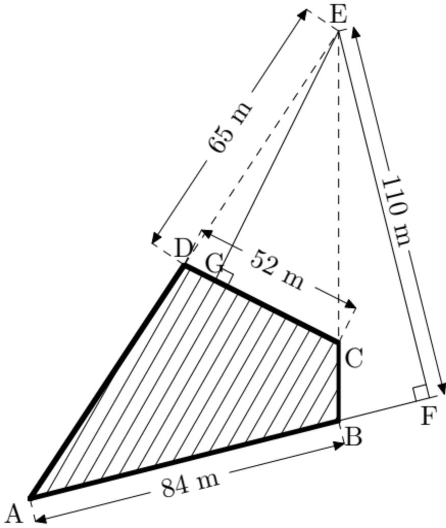
Pour calculer l'aire de l'étang représenté par la figure  $ABCD$ , un arpenteur mesure d'abord les longueurs  $AB$  et  $CD$ ; puis il détermine le sommet  $E$  du triangle  $ABE$  et mesure les longueurs  $EF$  et  $EG$ .
